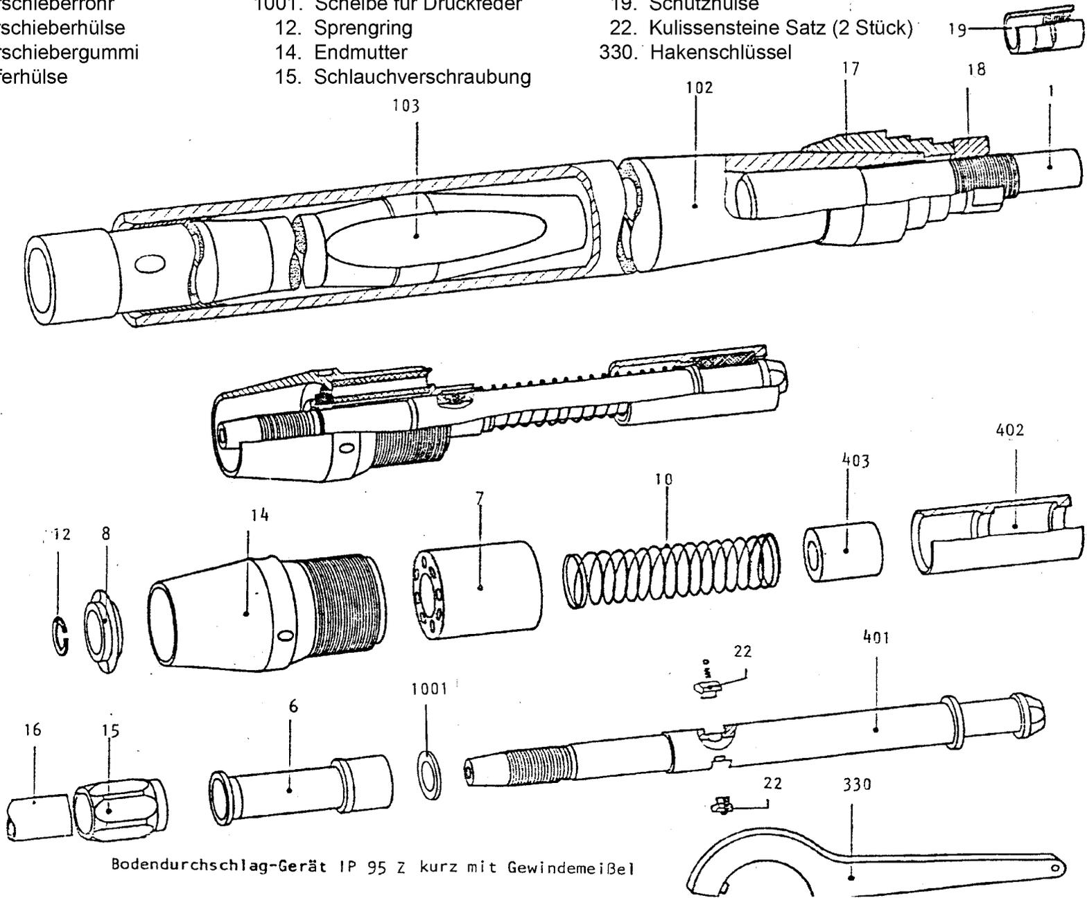
Bodendurchschlag-Gerät IP 95 Z kurz mit Gewindemeißel
